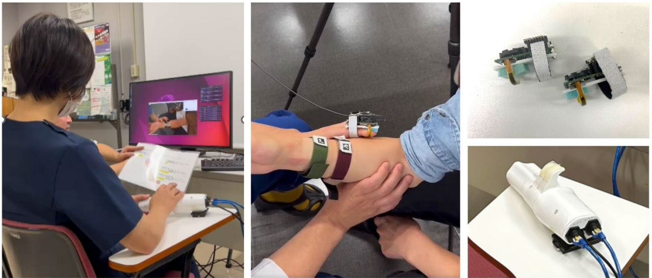
図2. 函館・帯広・札幌3拠点遠隔触診実験の様子 (左：受信側、中央：送信側、右上：センサデバイス、右下：触覚再現器)
