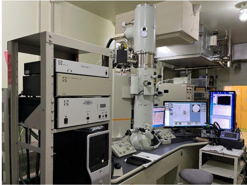
図 2. 液中観察を主目的として構築してきた透過型電子顕微鏡 (JEM-2100F、日本電子)。中心の円筒状の筒が本体の鏡筒部分。本研究では、この装置に組み込んだ電子線をパルス化できる電子線照射変調スマートシステム (ID-7000EDM、日本電子) と液体セル試料ホルダー (Poseidon, Protochips, Inc.) を用いた。
