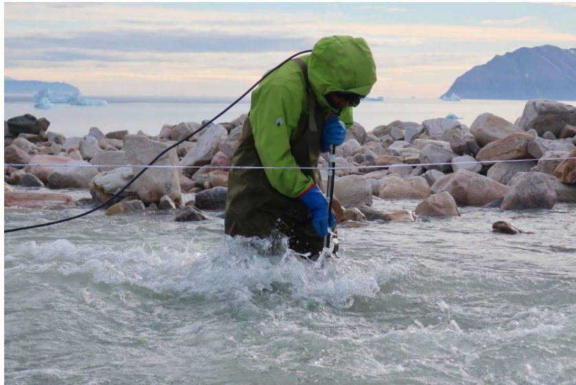
図 2. 通常の河川の流量は、冷たい水流の中で大変な労力をかけて行う。本研究では、このようにして測定した流量を、音響センサで記録したシグナルと比較した。
