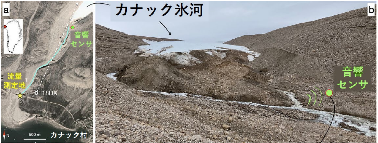
図 1. (a) 研究を行ったグリーンランド北西部カナック氷河。(b) 氷河末端から流出する河川で、音響センサを使って流量を測定。
