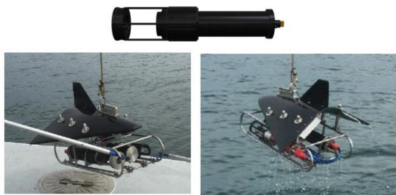
図3. 2022年11月に就航した、うしお丸III世に導入された現場曳航型画像イメージング機器。
