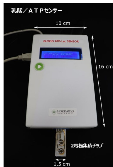
図1 乳酸/ATPセンサーの原理と外観(写真)
