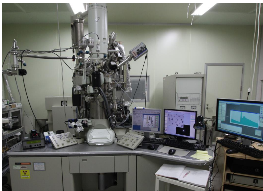
図 1. 新たに開発した氷作製・観察のための超高真空極低温透過型電子顕微鏡
