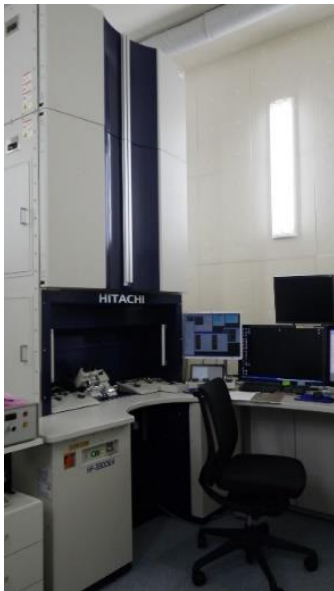
図 2. ナノ領域の磁場を直接観察できるホログラフィー電子顕微鏡（一般財団法人ファインセラミックスセンター，日立製 HF3300-EH）。
