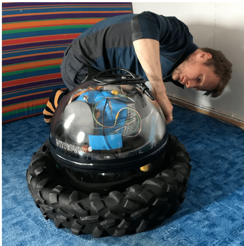
図 3. グリーンランド北西部の村、カナックで海底地震計を組み立てるエヴゲニ・ポドリスキ助教（2019年7月。撮影：浅地 泉）。
