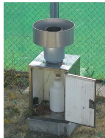
屋外に設置した沈着サンプラー
