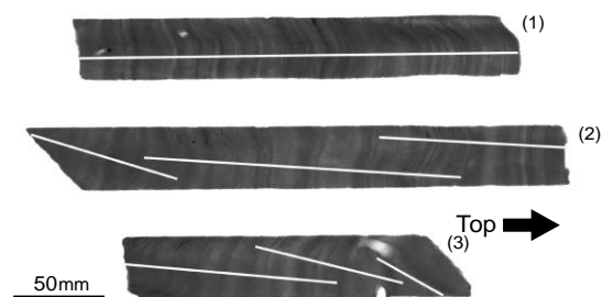
図 2. 採取したサンゴの骨格柱状試料の軟 X 線画像。白線部位から粉末試料を採取し，化学分析に使用した。
